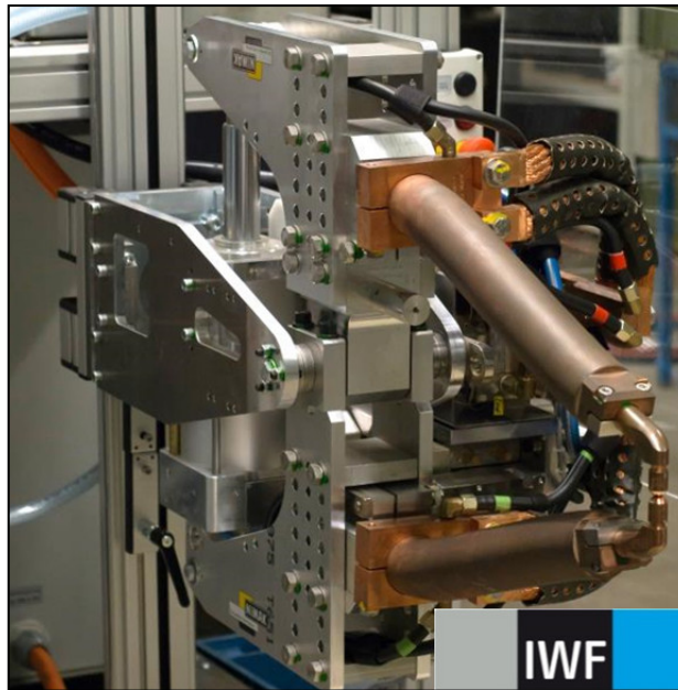
Schweißzange zum Widerstandspunktschweißen am IWF
