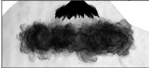
Hochgeschwindigkeits-Schlierenaufnahme von zwei Einspritzungen zur Unterscheidung von Dampf- und Flüssigkeitsphase
