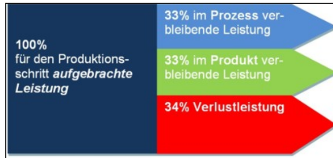
Exemplarisches Energie-Sankey-Diagramm (verfremdet)
