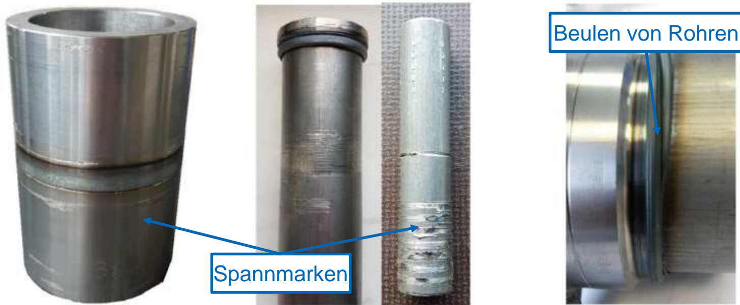
Abb.: Oberflächenschäden (Spannmarken) auf dickwandigen Rohrbauteilen (links), Vollwellenbauteilen (mitte) und Beulen von dünnwandigen Rohrbauteilen in Folge von Bauteilschlupf und Spankräften beim Reibschweißen (rechts).
