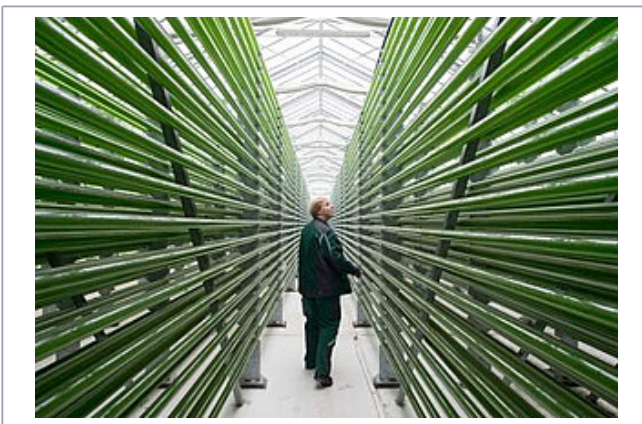
Ein Bioreaktor gefüllt mit Algen in der Firma "Roquette" in Klötze. In dem Glasröhrensystem werden Algen etwa für die Lebensmittel- und Kosmetikindustrie gezüchtet. Ähnlich sehen auch die Inkubatoren des Forschungsprojektes aus, das Algen auf gesundheitsfördernde Nährstoffe untersucht. Foto: dpa
