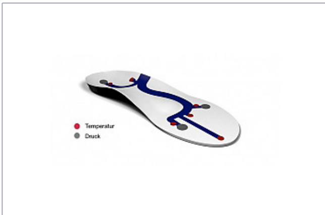
Modell der intelligenten Einlegesohle und Position der Sensoren.(entwickelt von Thorsis Technologies GmbH und Medixmind GmbH)
