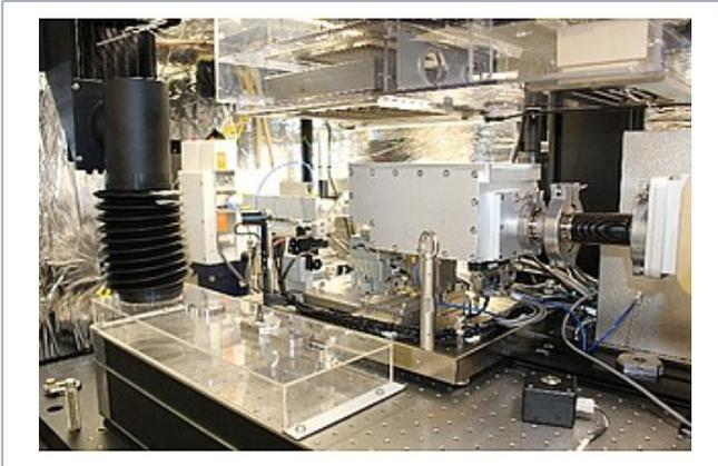
Das Röntgenmikroskop ZEISS Xradia 810 Ultra wird künftig in Halle zur Materialforschung genutzt. Foto: Fraunhofer IMWS
